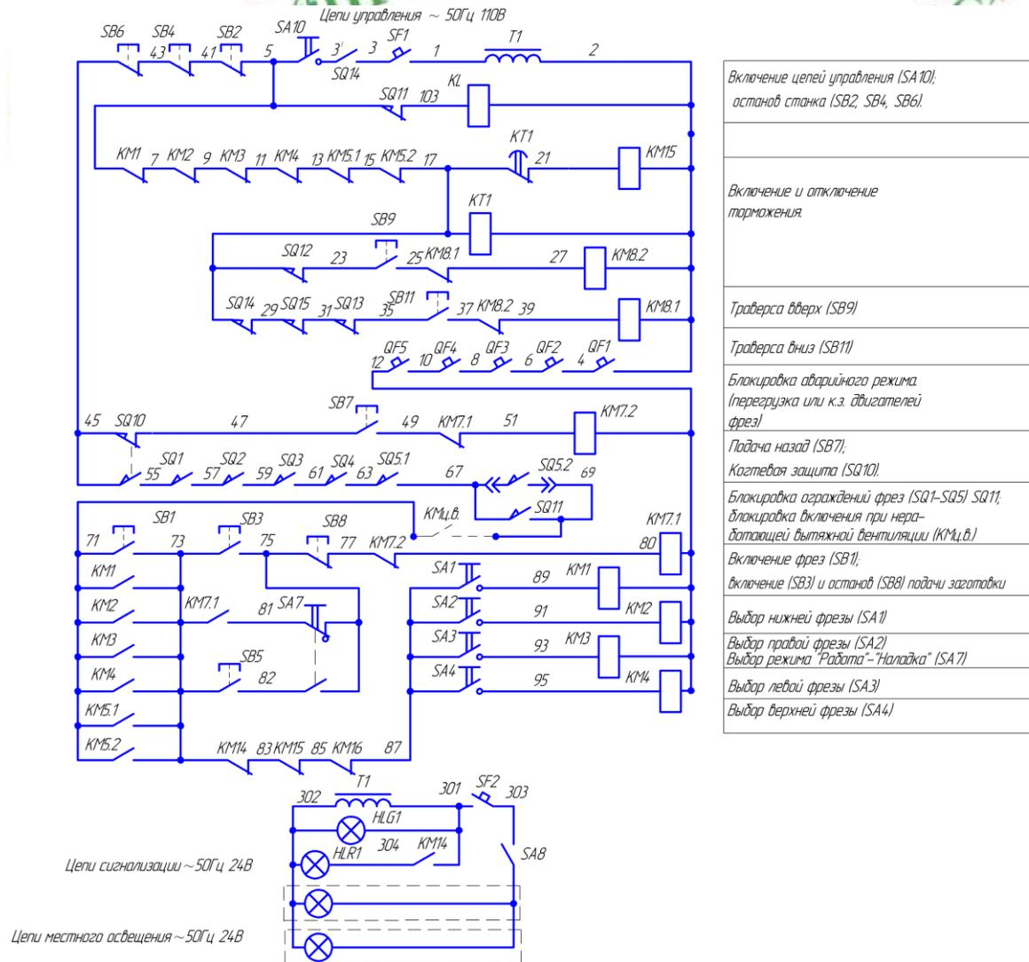
Рис. 23. Схема электрическая принципиальная станка модели C25-4A
