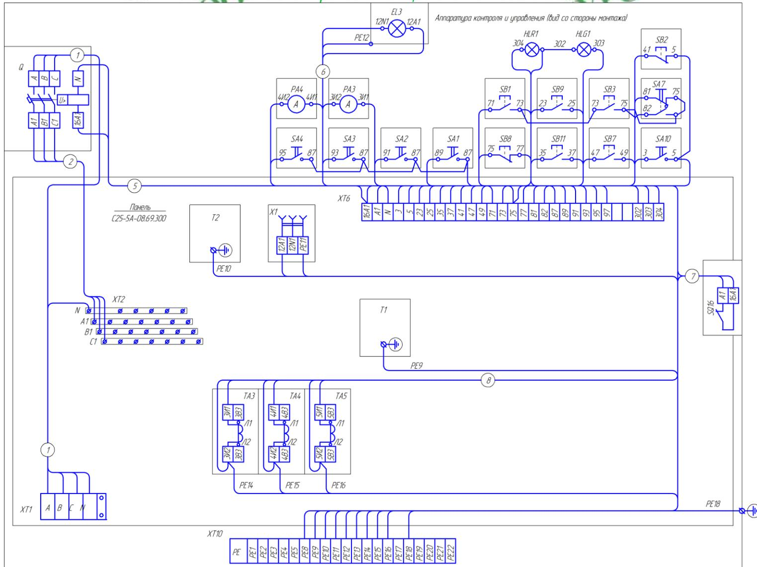
Рис. 25. Схема электрическая соединений станка модели С25-4А
