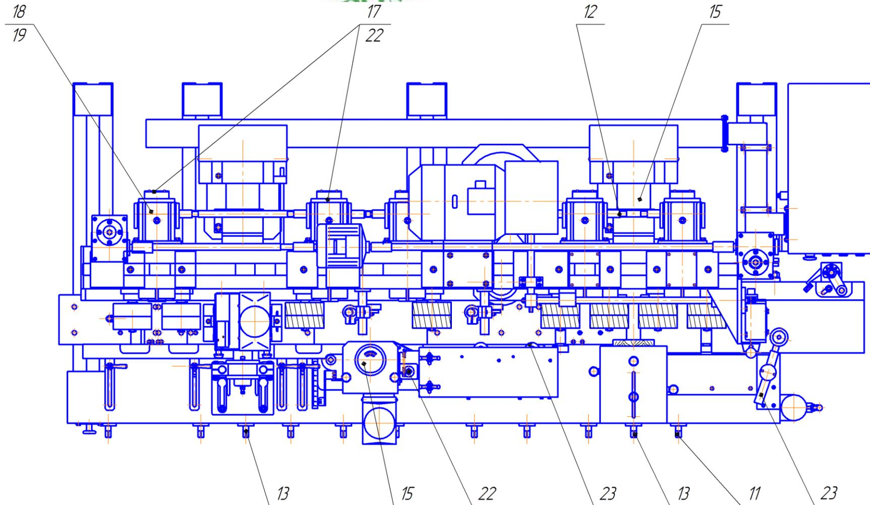
Рис. 27. Схема смазки станка
