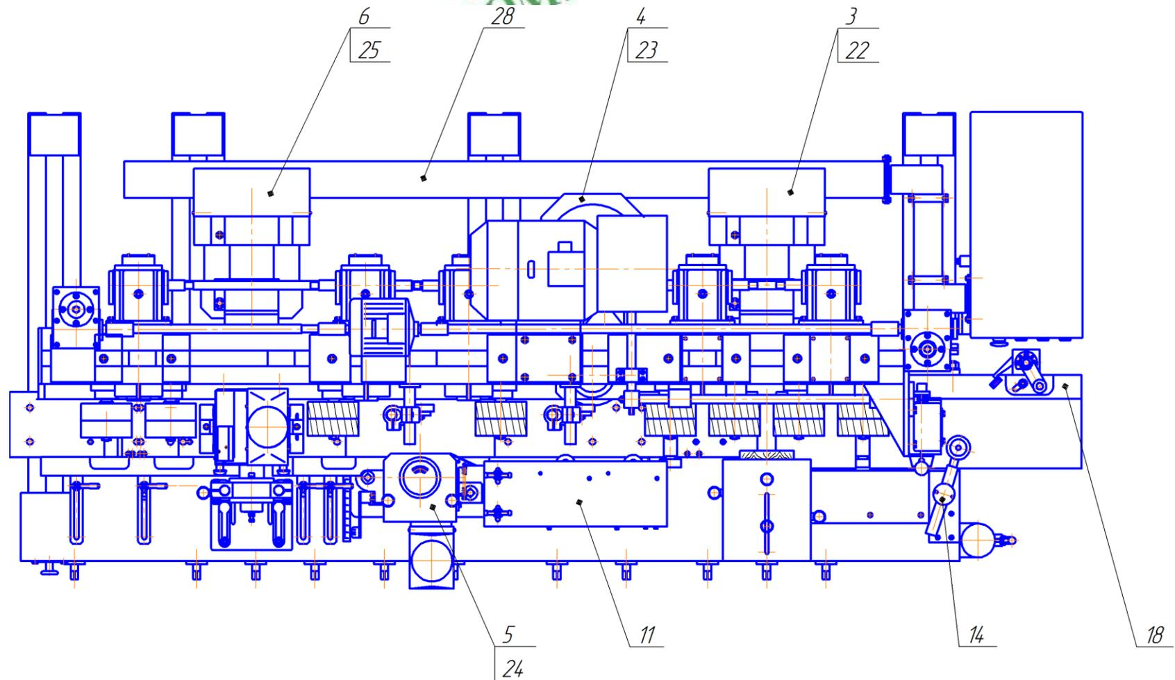
Рис. 4 Расположение составных частей станка.
