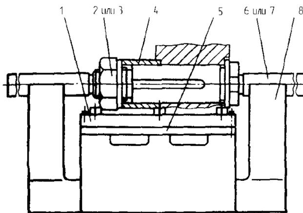
Рис. 4.8. Приспособление для установки ножей сборных фрез ИП.23.000
