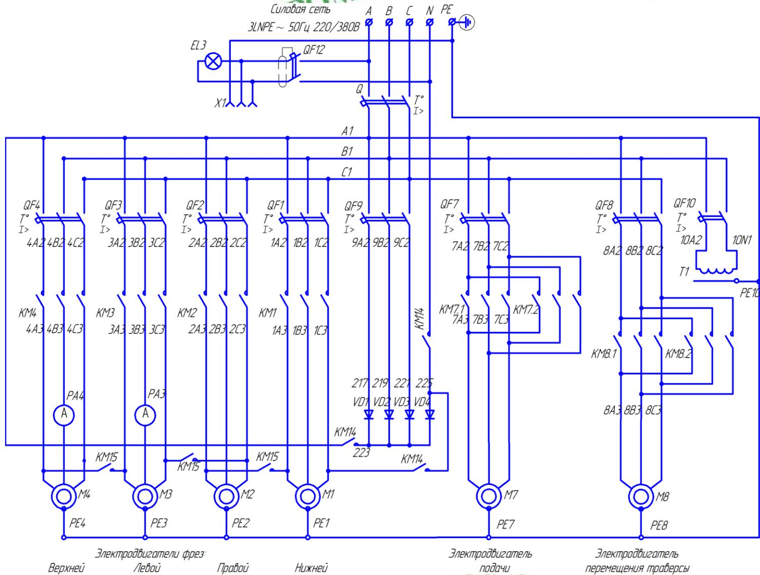
Рис. 22. Схема электрическая принципиальная станка модели C25-4A
