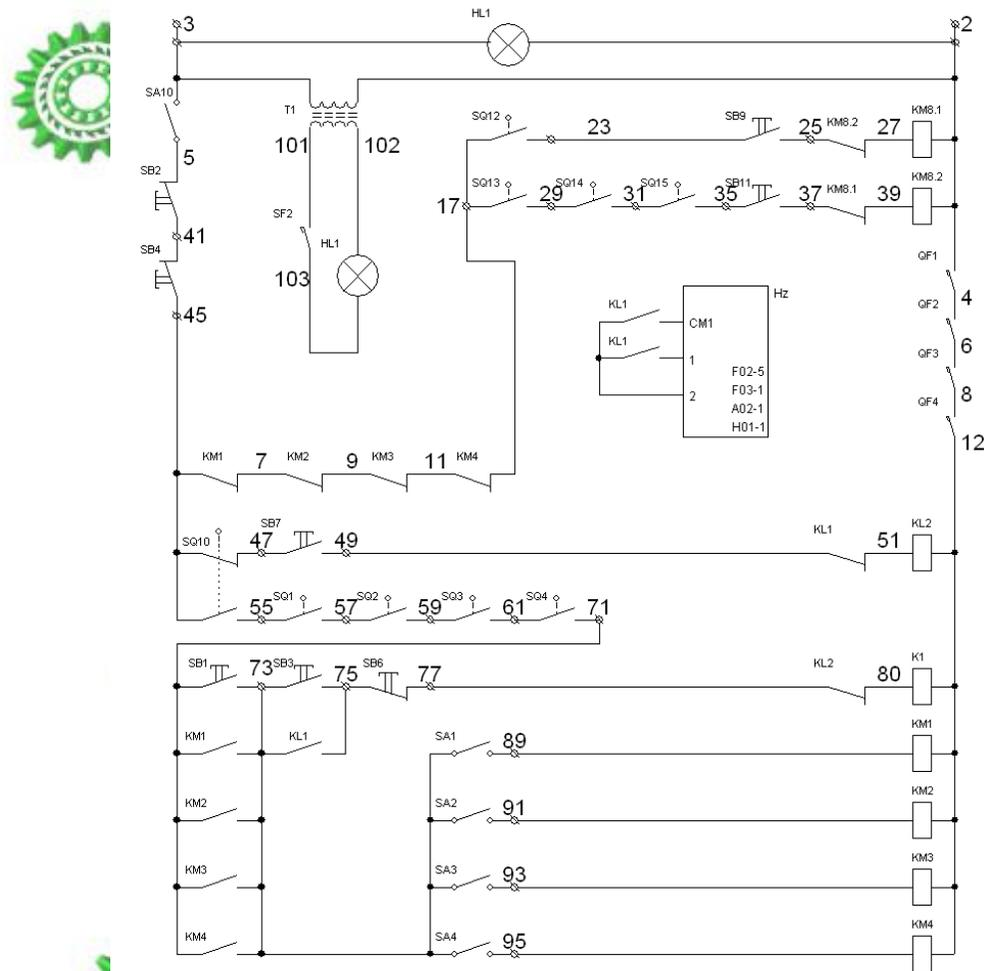
Схема электрическая принципиальная станка модели С25-4А
