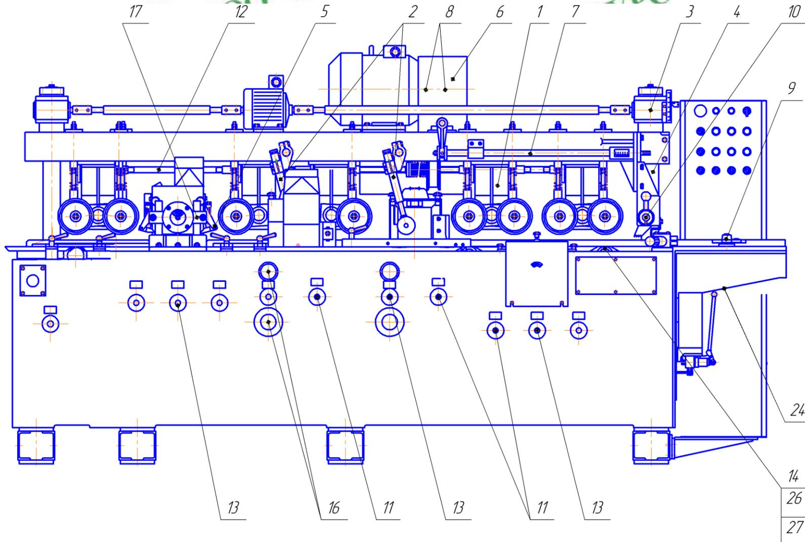
Рис. 26. Схема смазки станка
