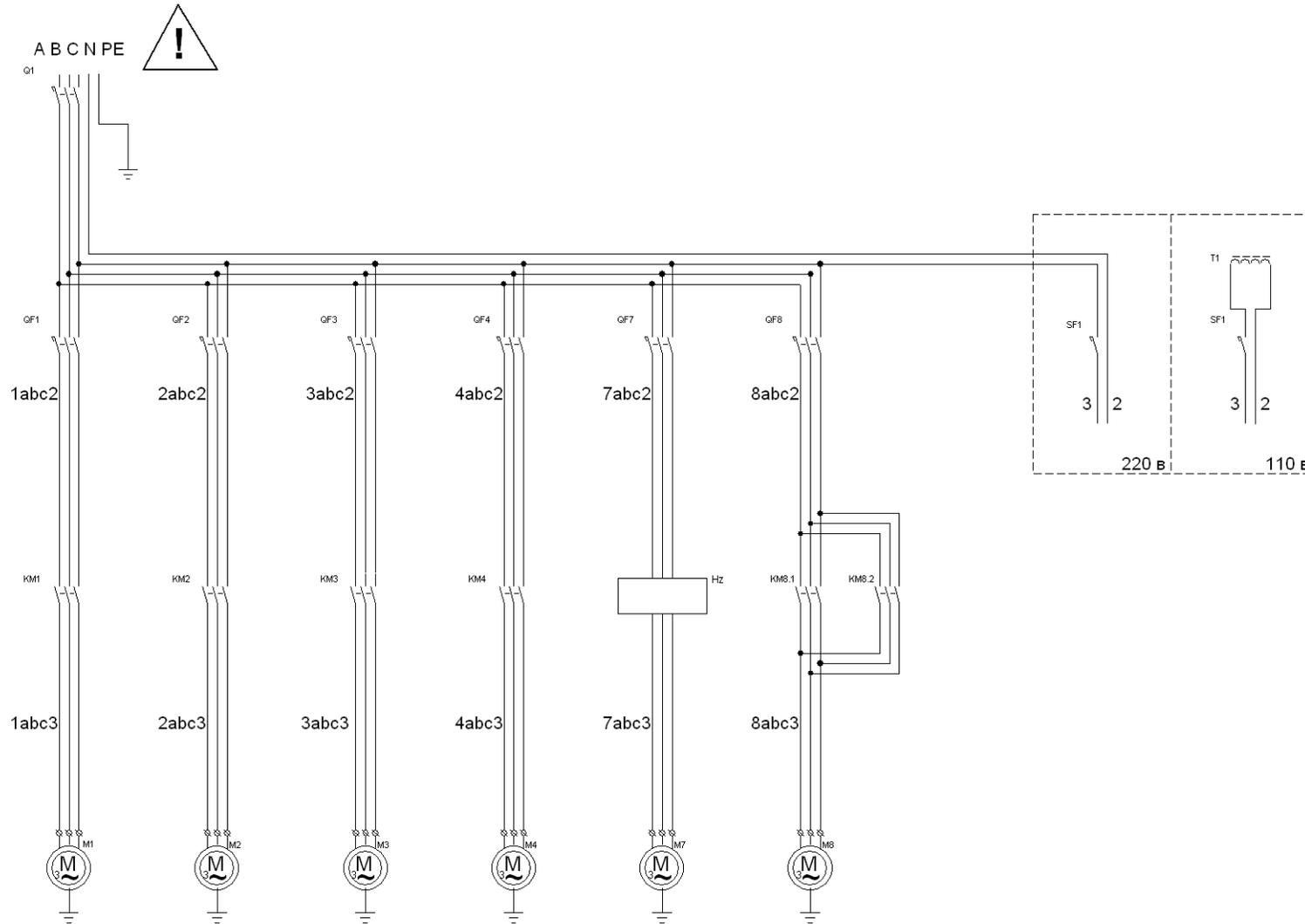
Схема электрическая принципиальная станка модели С25-4А
