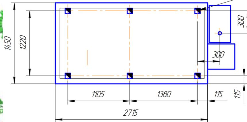
Рис. 29. Схема установки станка
