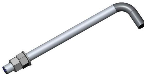
Рис. 4.9. Болт фундаментный 1.1.M20X330 Ст3 ГОСТ 24379.1-80
