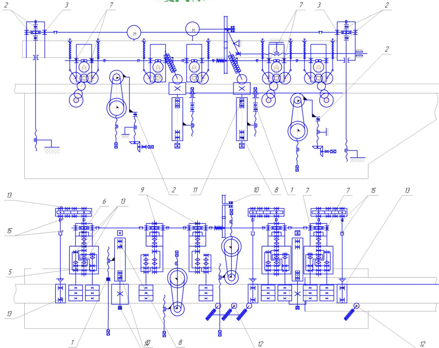
Рис. 36. Схема расположения подшипников
