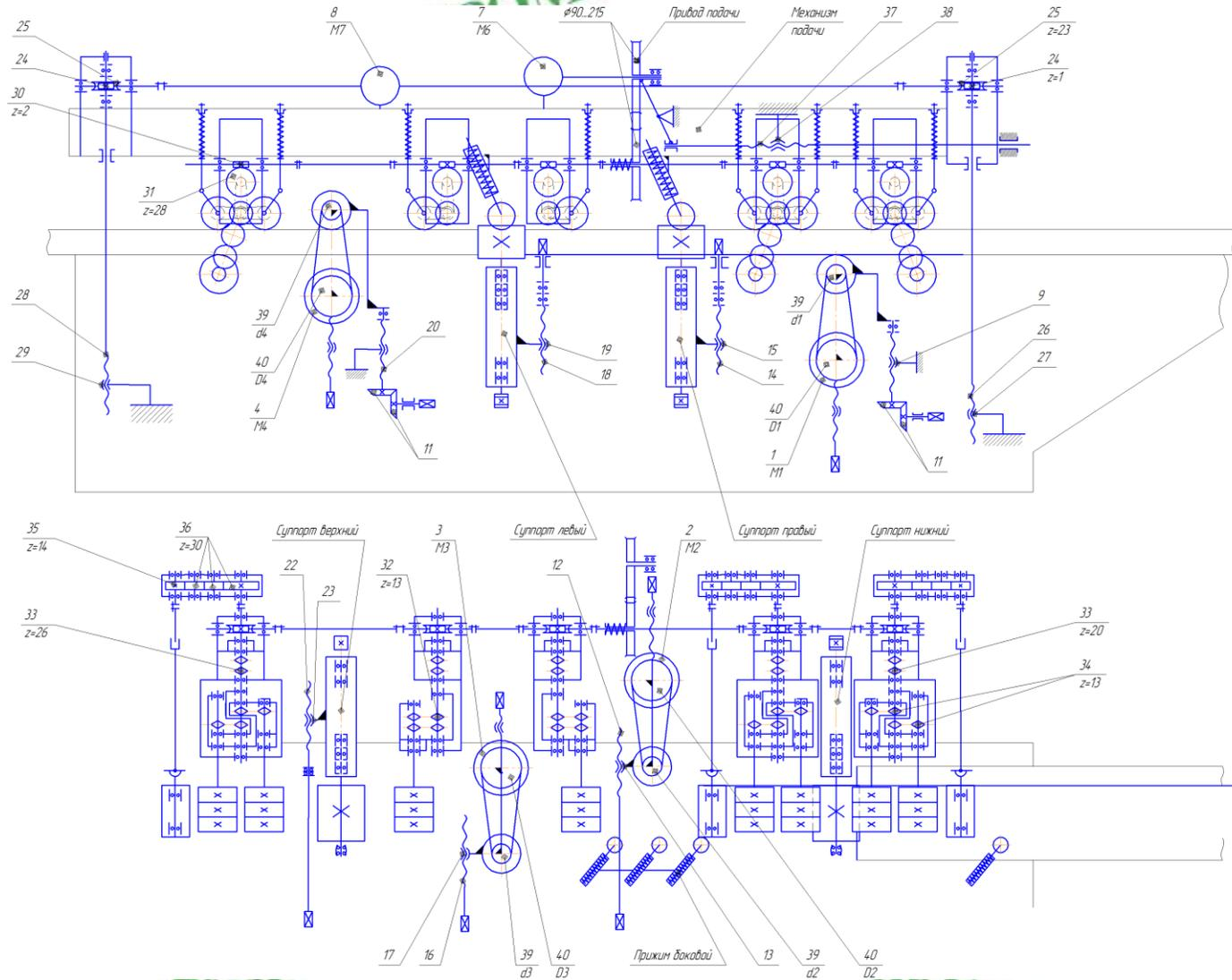
Рис. 8. Схема кинематическая станка С25-4А
