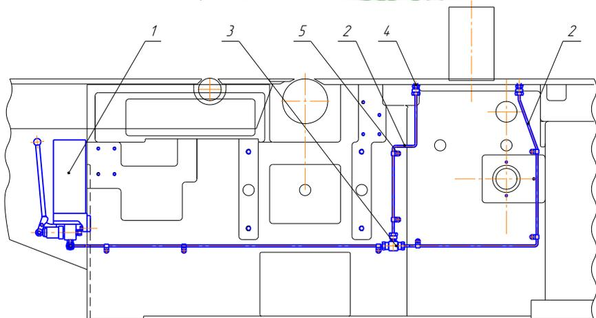
Рис. 30. Схема смазки столов станка
