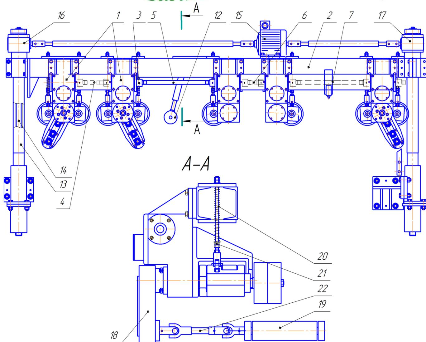
Рис. 10. Механизм подачи
