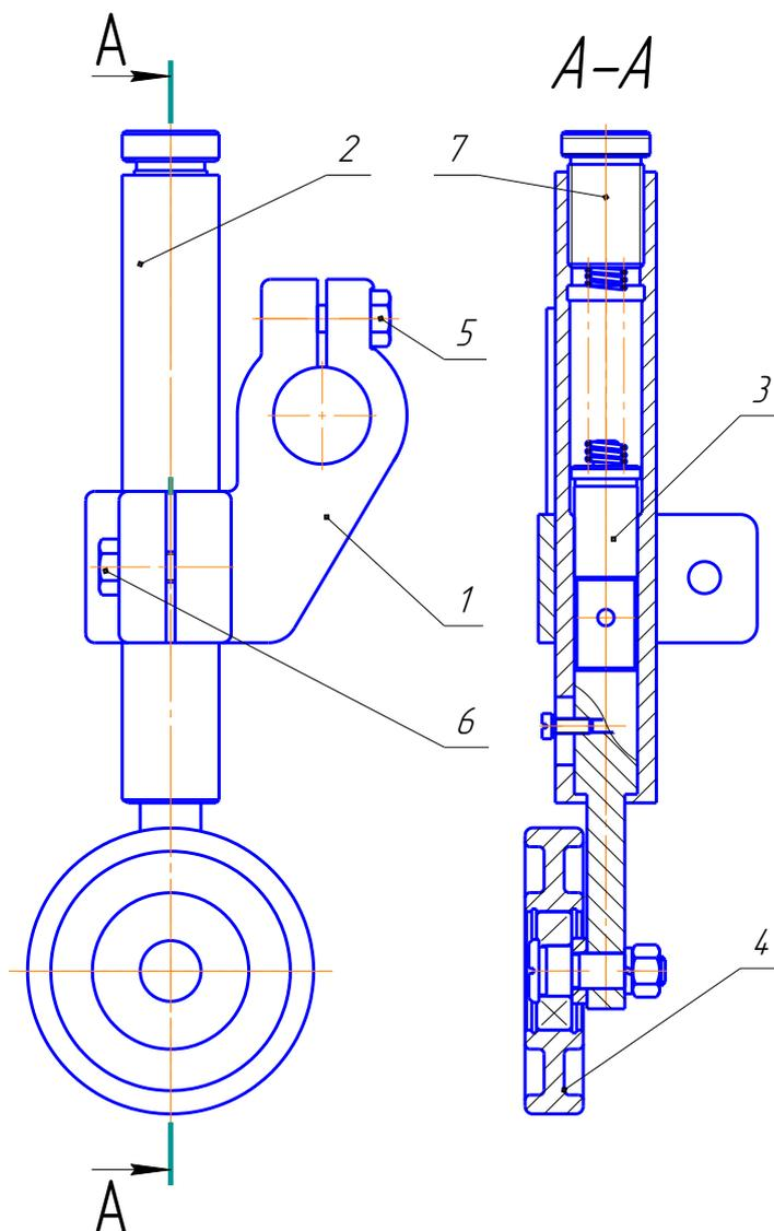
Рис. 13. Ролик прижимной
